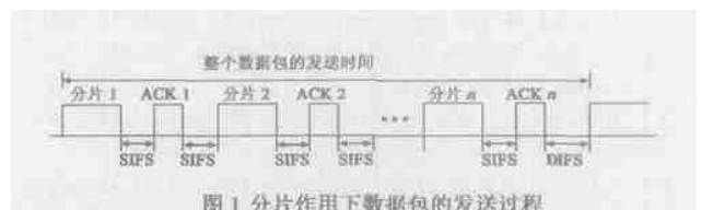
图 1 分片作用下数据包的发送过程
